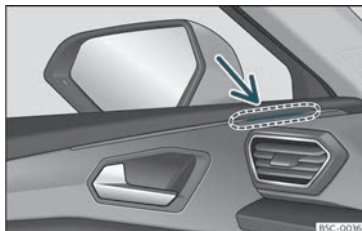
Fig. 166 Door: warning lamp
